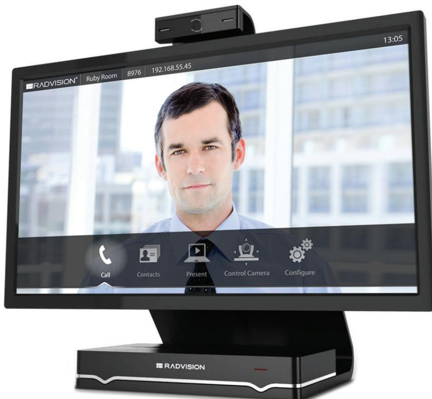
Для сотрудников руководящего звена, регулярно участвующих в видеоконференциях, будет удобным настольное устройство Scopia XT Executive 240. Оно объединяет в элегантном корпусе LED-монитор Full HD с диагональю 24", камеру высокого разрешения, высококачественные динамики, микрофоны с эхоподавлением и кодек на базе XT5000. В Scopia XT Executive 240 может быть встроен сервер MCU на 4 порта.
