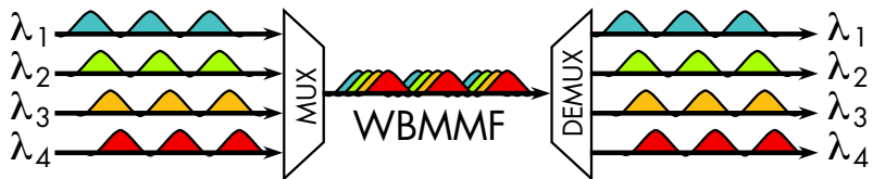
Рисунок 5. Система WDM с мультиплексированием четырех спектральных каналов
