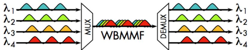
Рис. 22. Спектральное уплотнение с использованием широкополосного многомодового волокна (WBMMF)
