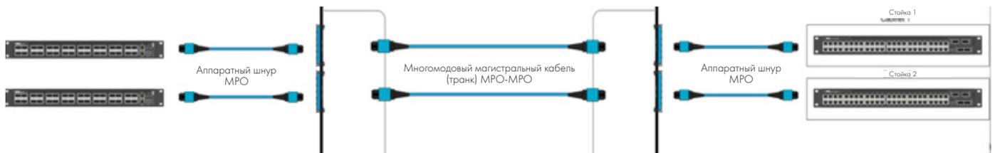
Рис. 3. Соединение 40-гигабитных коммутаторов по стандарту 40GBASE-SR4 (для простоты отдельные контакты одноволоконные коннекторы на рисунке не показаны).
