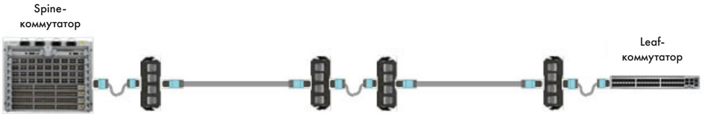
Рис. 7. Соединение leaf-spine, реализованное на основе многомодового транка с промежуточной распределительной зоной.
