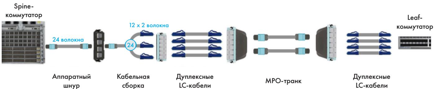
Рис. 9. Подключение с использованием кабельных сборок MPO-LC
