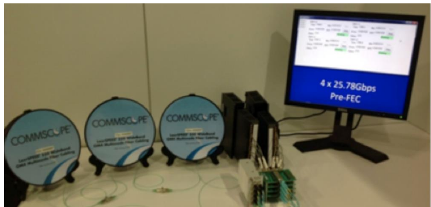
Рисунок 9. Система WDM 4 x 25 Гбит/с и MMB LazrSPEED 550 WideBand длиной более 225 м на конференции OFC 2015
