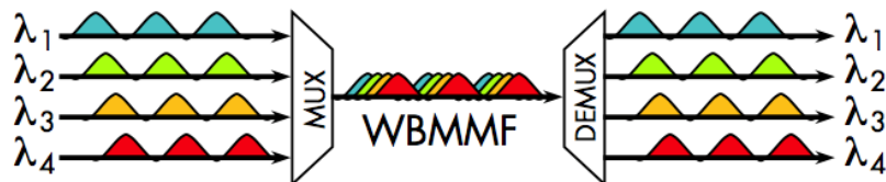
Рисунок 5. Система WDM с мультиплексированием четырех длин волн
