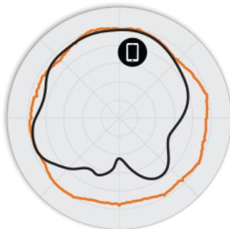
РИСУНОК 4 Вертикальная плоскость 2,4 ГГц R320 Диаграммы направленности антенны
