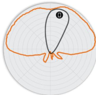
РИСУНОК 5 Вертикальная плоскость 5 ГГц R320 Диаграммы направленности антенны
